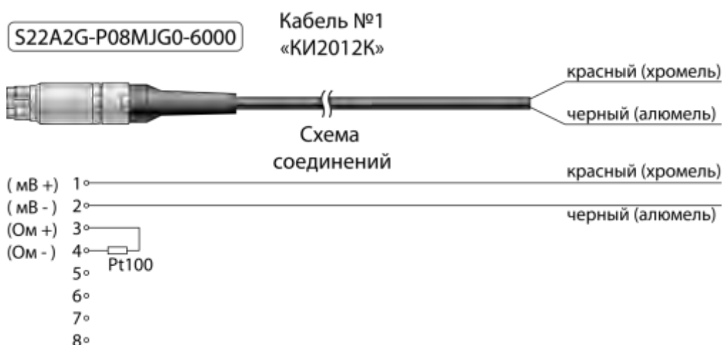
Рисунок А.5 – Соединительный кабель «КИ2012К» для подключения к ИКСУ ТП типа ТХА при работе в режиме измерения температуры, а также для связи с устройствами в режиме воспроизведения сигналов от указанного типа ТП
