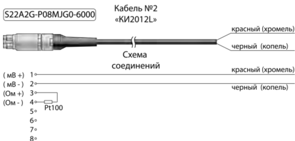
Рисунок А.6 – Соединительный кабель «КИ2012L» для подключения к ИКСУ ТП типа ТХК при работе в режиме измерения температуры, а также для связи с устройствами в режиме воспроизведения сигналов от указанного типа ТП
