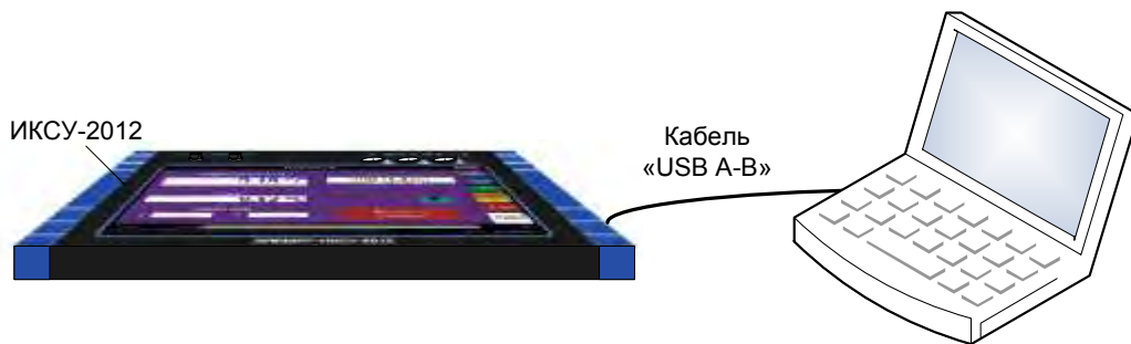
Рисунок 2.88 – Подключение ИКСУ-2012 к компьютеру
