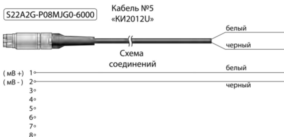
Рисунок А.9 – Соединительный кабель «КИ2012U» для связи ИКСУ с первичными преобразователями или устройствами при работе в режиме измерений напряжения постоянного тока, а также воспроизведения сигналов напряжения постоянного тока
