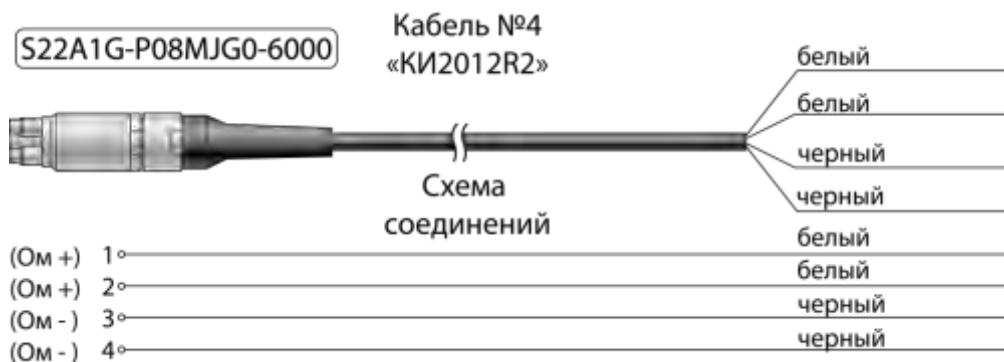
Рисунок А.8 – Соединительный кабель «КИ2012R2» для связи ИКСУ с устройствами по четырехпроводной, трехпроводной и двухпроводной схеме подключения в режиме воспроизведения сигналов от ТС и сопротивления постоянному току
