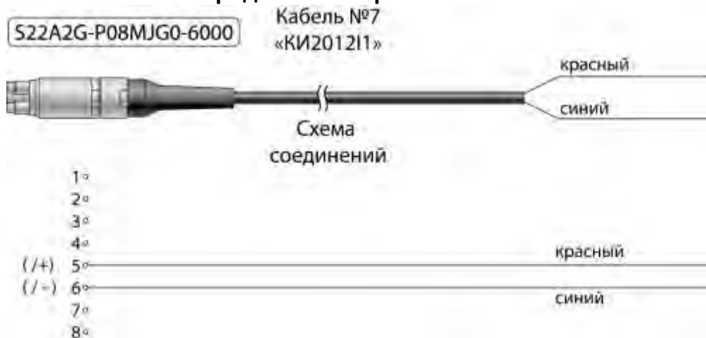
Рисунок А.11 – Соединительный кабель «КИ2012I1» для связи ИКСУ с устройствами при работе в режимах измерения и воспроизведения сигналов в виде силы постоянного тока с внешним блоком питания 24 В
