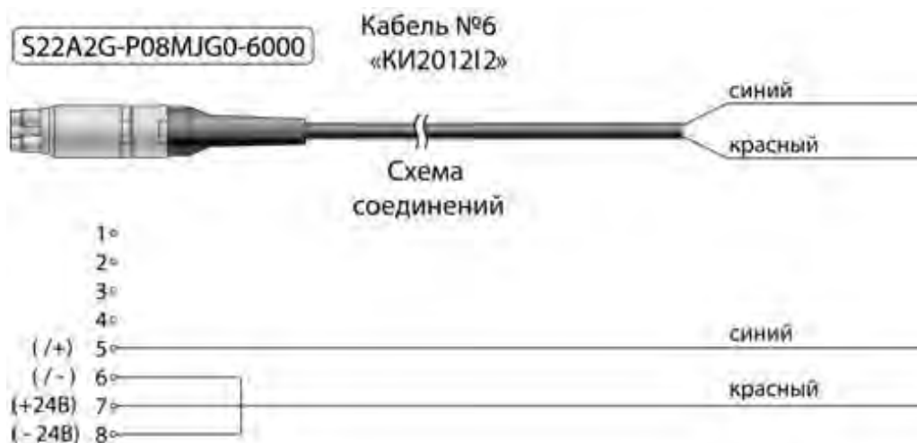
Рисунок А.10 – Соединительный кабель «КИ2012I2» для связи ИКСУ с устройствами при работе в режимах измерения и воспроизведения сигналов в виде силы постоянного тока с внутренним блоком питания 24 В
