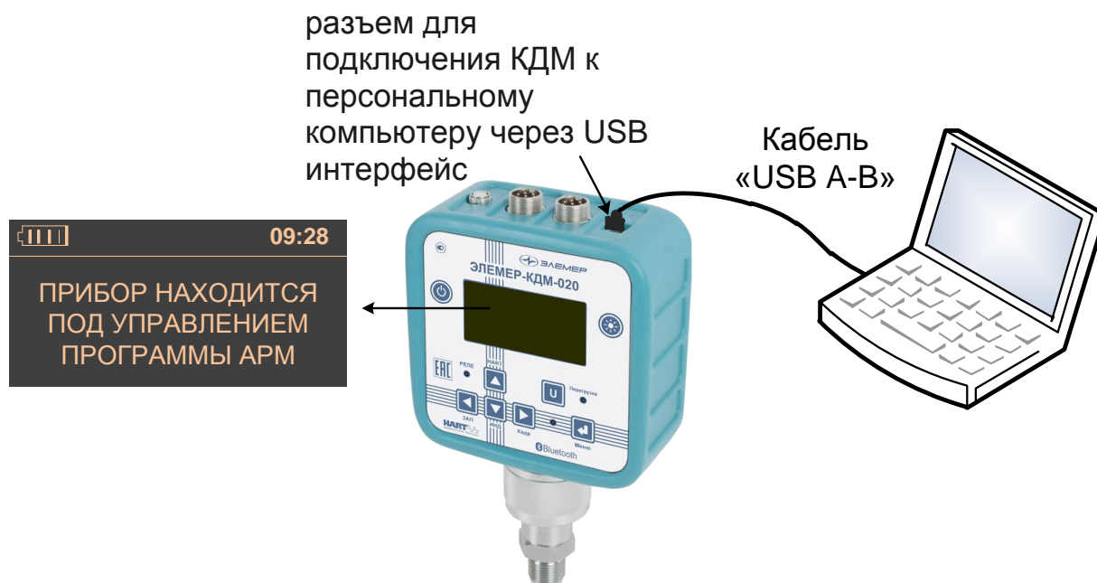
Рисунок 2.44 – Подключение КДМ к ПК (с использованием кабеля «USB A-B»)
