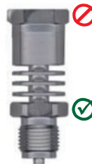
Установка охлаждающего элемента
