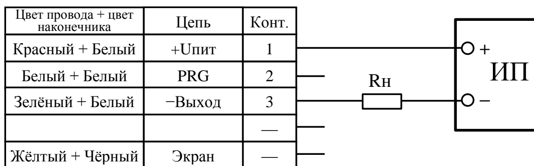
Рисунок В.3 — Соответствие цепей выводам разъёма преобразователей с кодами исполнений 14 и 15 по таблице А.10
