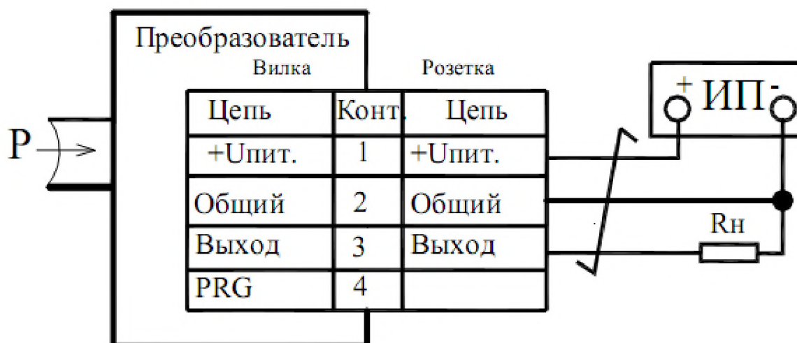
Рисунок Б.1 - Схема подключения преобразователей с разъемами DIN 43650 А и 2PMDT18B4Ш5B1B
